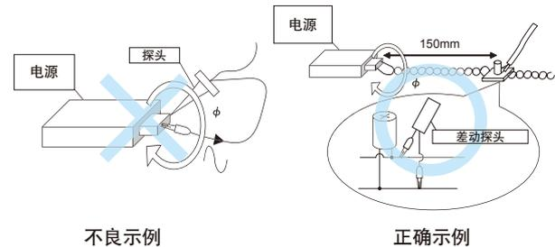
图1.2 输出纹波噪声的测量示例
